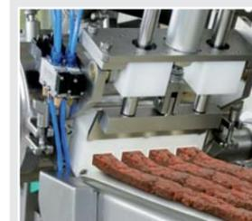
Elaboración en varias vías: Distribuidor de caudal de llenado automático para caudales de llenado idénticos en la elaboración de varias vías. Los caudales de llenado pueden repartirse de forma variable.
